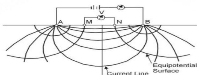
Figure 2.0: Schlumberger array (Wightman, et al., 2003).
